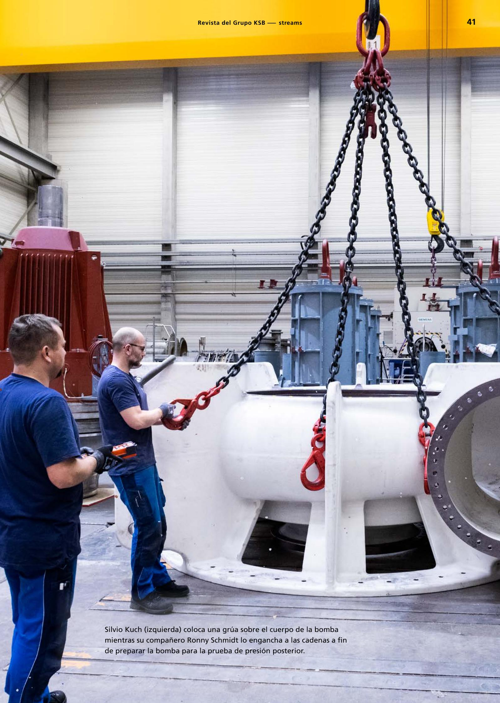
Silvio Kuch (izquierda) coloca una grúa sobre el cuerpo de la bomba mientras su compañero Ronny Schmidt lo engancha a las cadenas a fin de preparar la bomba para la prueba de presión posterior.
