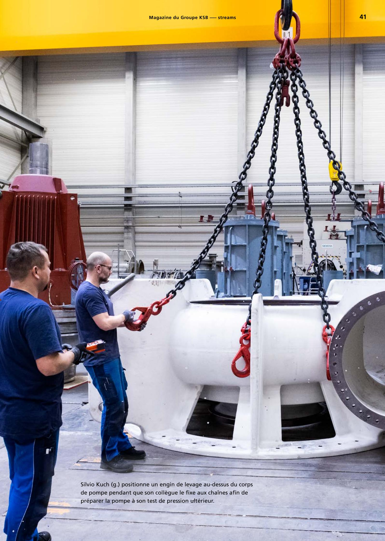
Silvio Kuch (g.) positionne un engin de levage au-dessus du corps de pompe pendant que son collègue le fixe aux chaînes afin de préparer la pompe à son test de pression ultérieur.
